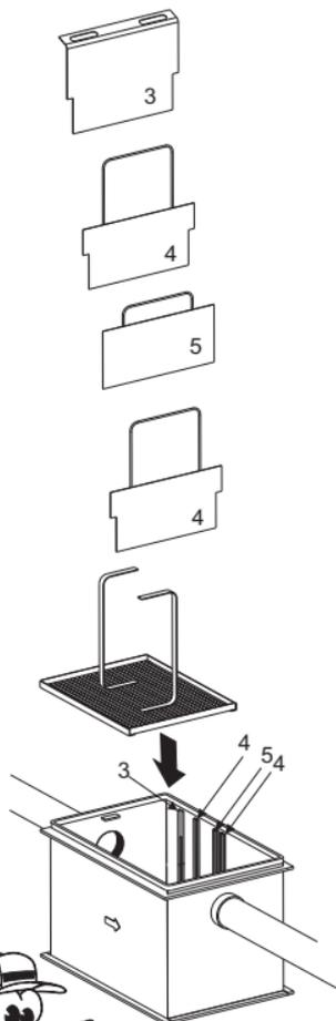
Para un correcto funcionamiento coloque cada componente en su posición original.
