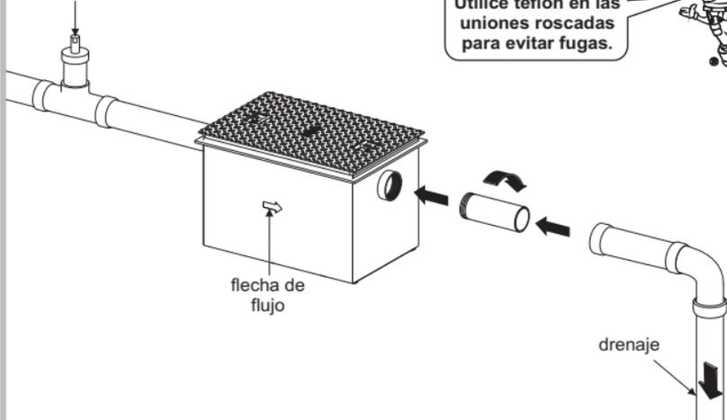
Utilice teflón en las uniones roscadas para evitar fugas.
